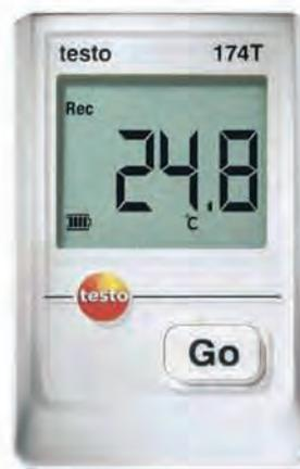
Mini datalogger para control de temperatura ▲
